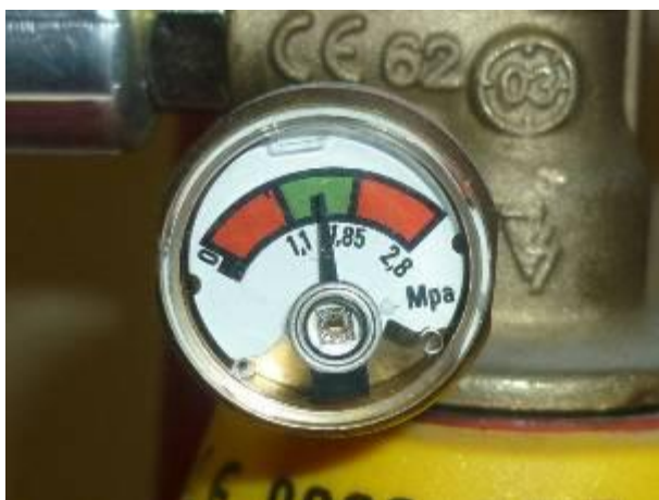
Estintore dal cui manometro è visibile la corretta pressione interna.
