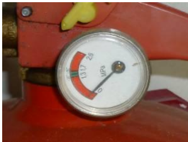
Estintore dal cui manometro è visibile che la pressione interna non è corretta .
